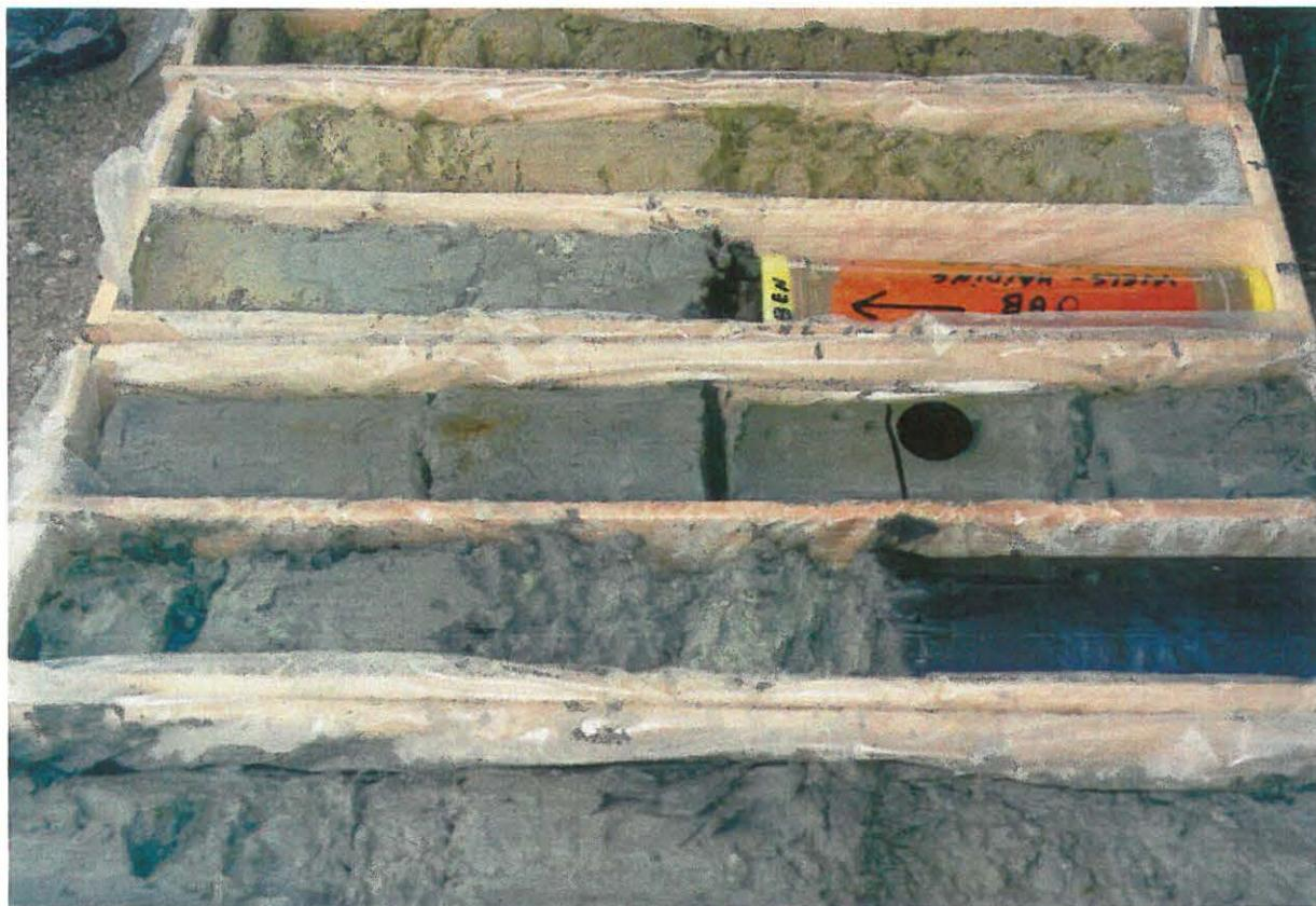
Abb. 4: Feinsandig, stark schluffige Ausedimente im Baulos Wels - Haiding (ÖK 49)
