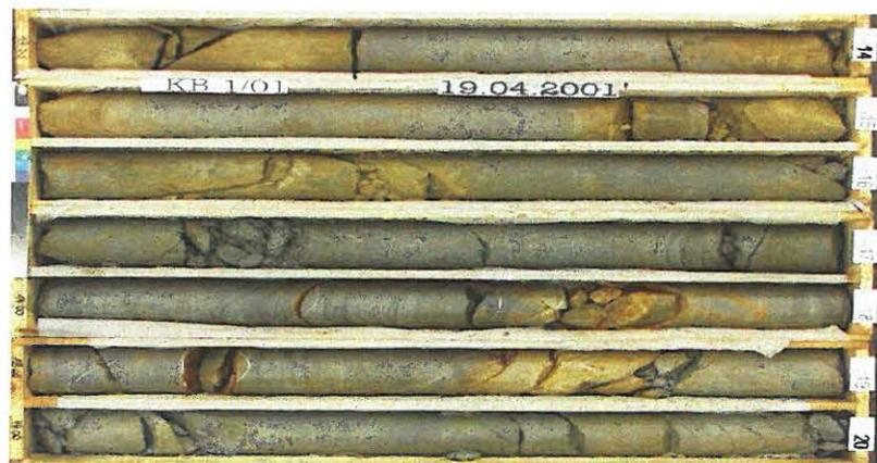
Abb. 17: Kernbohrung innerhalb der Rhenodanubischen Flyschzone -
